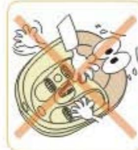
搬运机器时，应双手抓握机器两侧水平端放，以免造成损坏。
